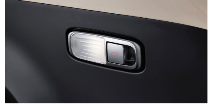
Bagaj Kapağı İç Açma Düğmesi
