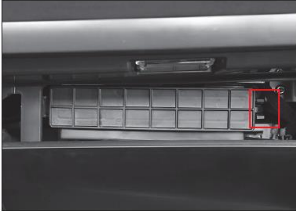
4. Klima kapak sağ tarafına basarak polen filtresini çıkarın
