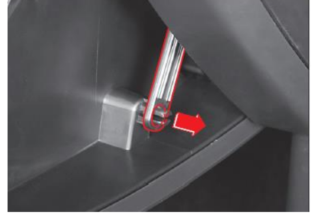
3.Torpido kutusunun sağ tarafındaki klipsi çıkarın
