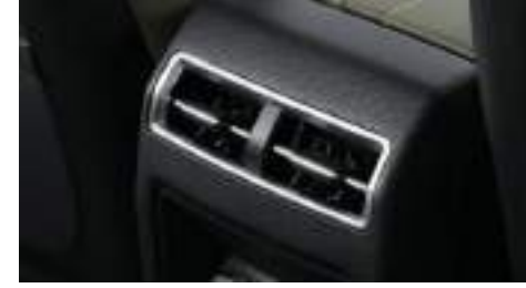
Arka orta konsol havalandırması
