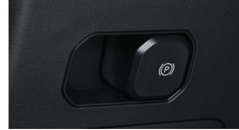
Otomatik tutma işlevli elektronik park freni
