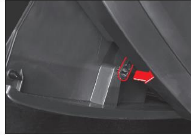
3. Torpido kutusunun sağ tarafındaki klipsi çıkarın
