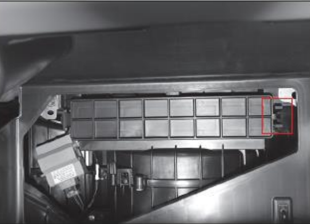
4. Klima kapak sağ tarafına basarak polen filtresini çıkarın
