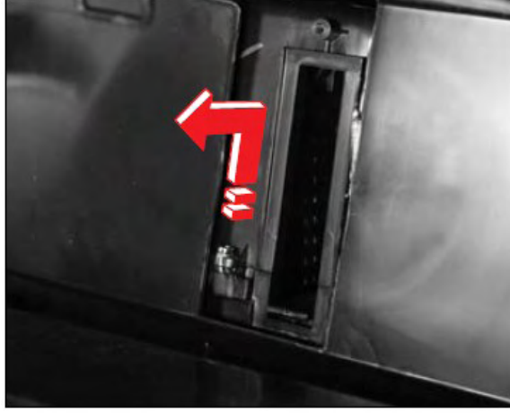
5. İkinci filtreyi yukarı kaldırın ve çıkarın
