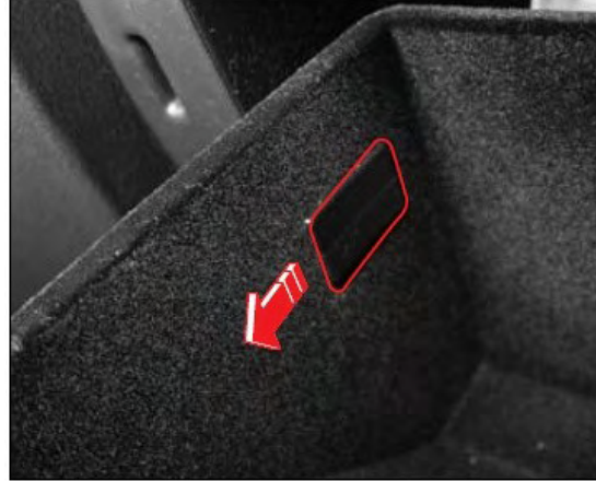
2. Torpido kutusu içindeki tutucuyu ok yönünde çekiniz.
