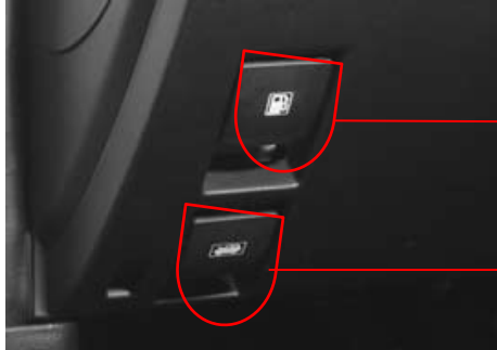
Motor kaput ve depo kapak açma mandalı
